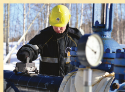
Ультразвуковая диагностика трубопроводного парка
